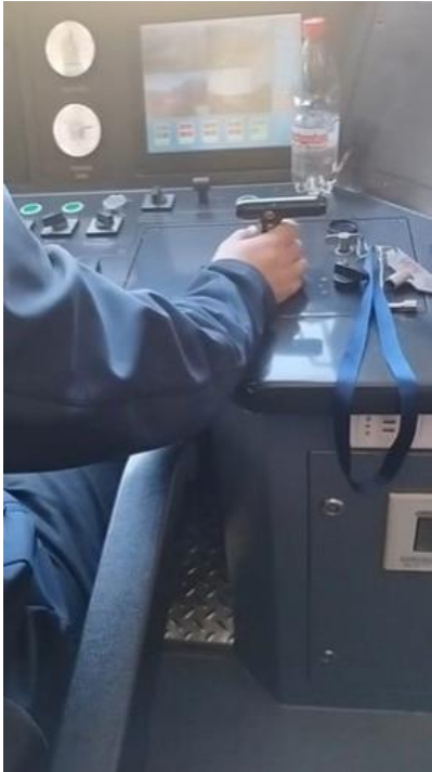
Figura N° 23. Operación palanca de control de velocidad
